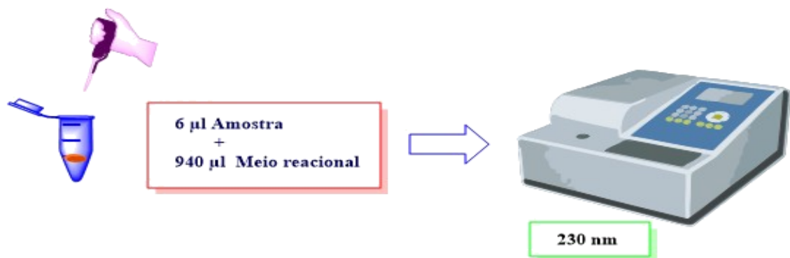
Figura 8: Protocolo de determinação da atividade da catalase (CAT).
